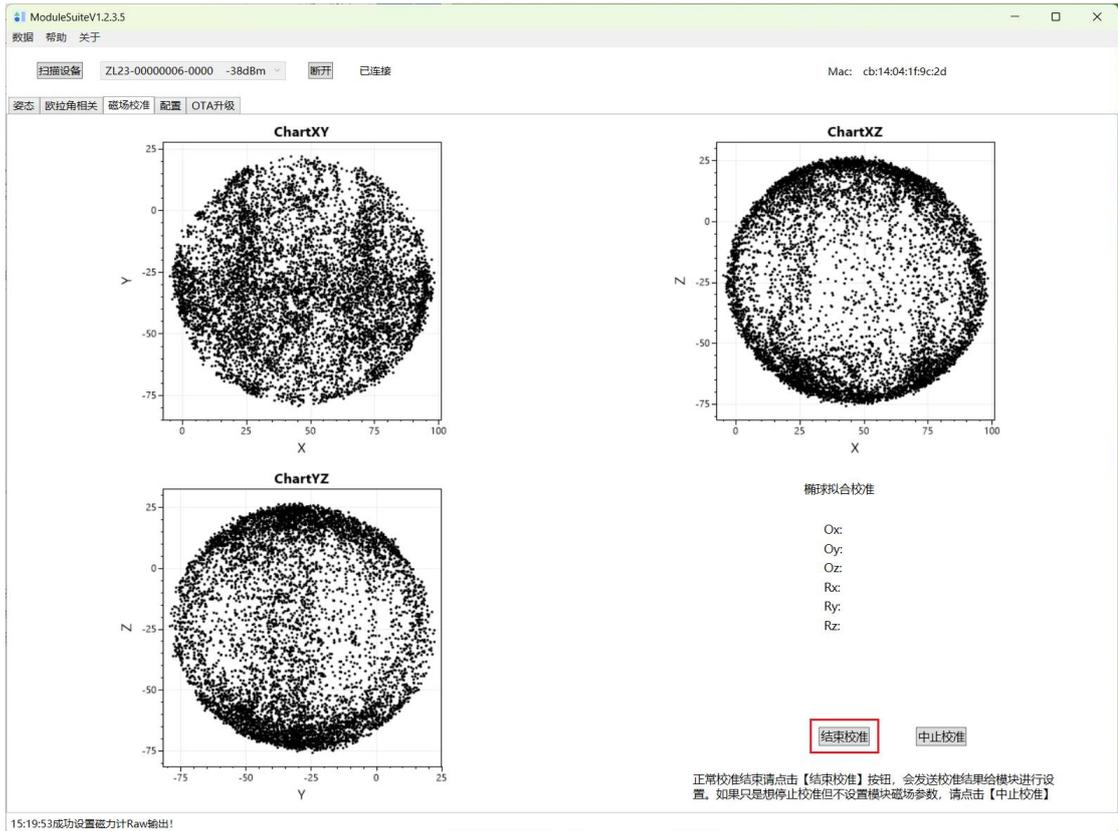
【中止校准】按钮，是在校准中途停止校准，也不进行参数计算，不会向模块写入参数。
