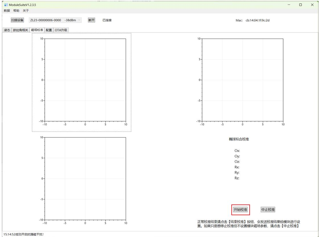
手握模块在空间中进行各种方向的翻转，或者绕模块的三轴做顺时针、逆时针的旋转。
