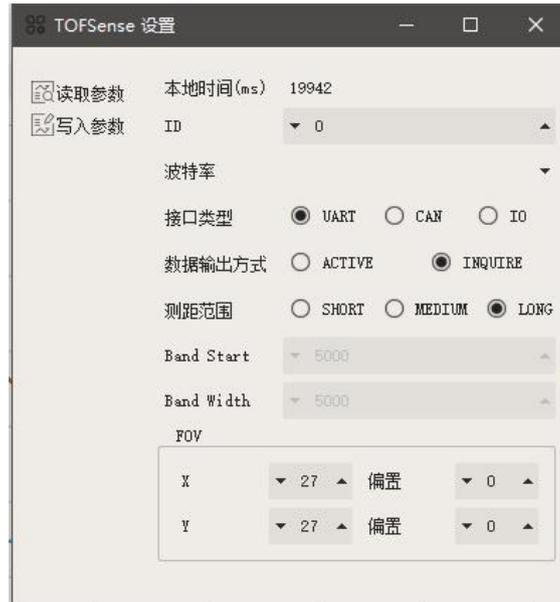
图 2: UART 查询输出模式配置图
