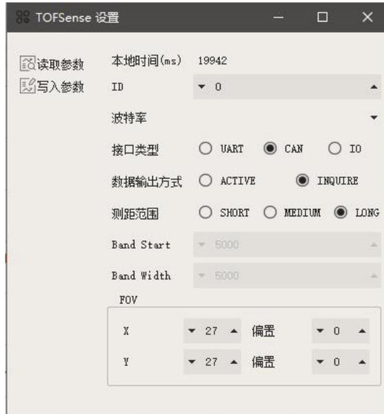
图 4: CAN 查询输出模式配置图
