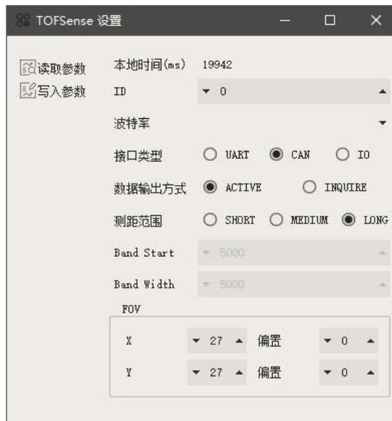
图 3: CAN 主动输出模式配置图
