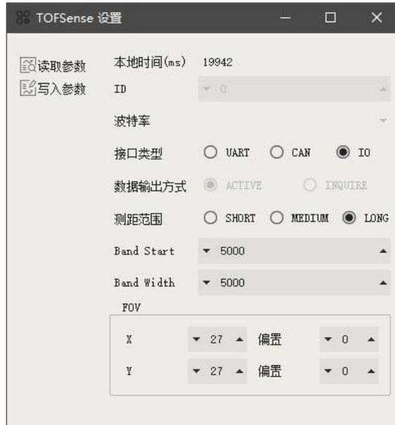
图 5: I/O 输出模式配置图
