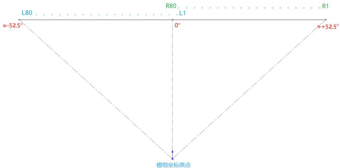
图 2 GS2输出点云角度示意图
