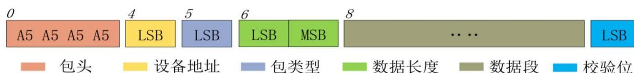
图 4 GS2 系统报文数据协议示意图
