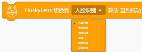
切换算法,可以随时切换到其他算法,同时只能存在一个算法,注意切换算法需要一些时间。
