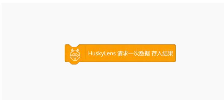
主控板向 HUSKYLENS 请求一次数据存入“结果”（存在主控板的内存变量中, 一次请求刷新一次存在内存中的数据), 之后可以从“结果”中获取数据, 此模块调用之后“结果”中才会获取到最新的数据。
