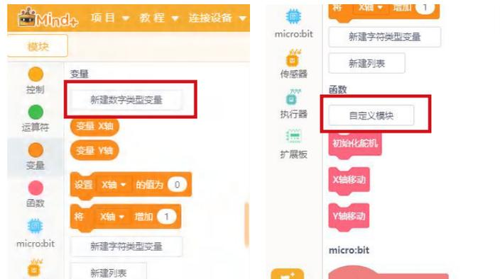
2、对三个自定义模块函数进行定义，首先是初始化舵机，目标是将舵机位置移动到初始值，并将舵机的旋转角度于变量“X 轴”和“Y 轴”进行了关联
