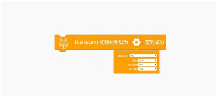
初始化, 仅需执行一次, 放在主程序开始和循环执行之间, 可选择 I2C 或串口, I2C 地址不用变动。**注意 HUSKYLENS 端需要在设置中调整“输出协议”与程序中一致, 否则读不出数据。**
