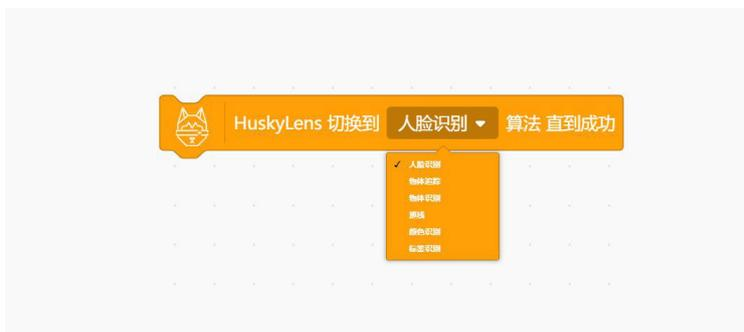
切换算法, 可以随时切换到其他算法, 同时只能存在一个算法, 注意切换算法需要一些时间。
