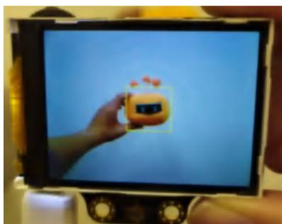
**追踪物体**是通过上一步得到的物体的外观信息，根据物体的外观特征，使用算法对后面的图像序列进行跟踪，并且可以在后续的追踪中进行更深入的学习，使追踪越来越精确。如图中，在移动中缓慢旋转物体，可以对其进行多角度学习。
